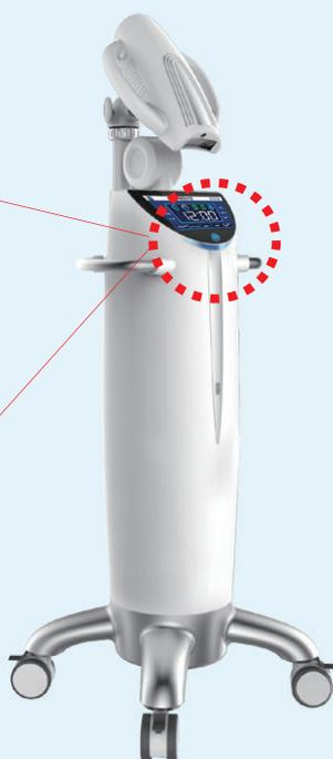
⑮冷却ファン停止確認後、スイッチを下(○)にさげる
